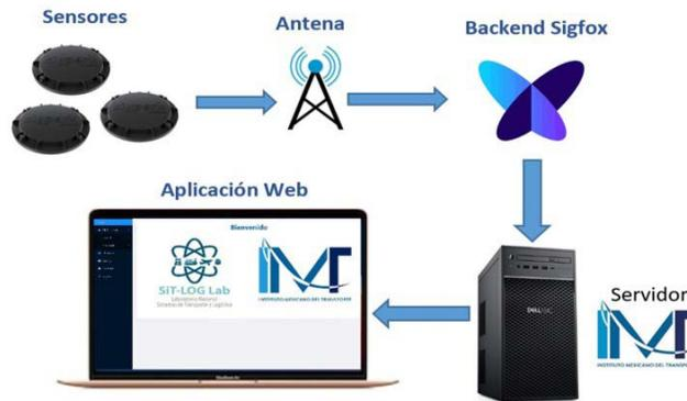
Figura 8. Diagrama de conectividad IoT
