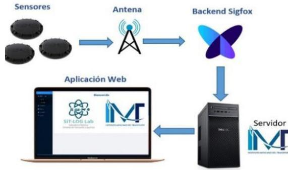
Figura 3. Diagrama de conectividad IoT. Fuente: elaboración propia.
