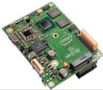
Figura 9. Computadora Intel Aero Fuente: https://software.intel.com
