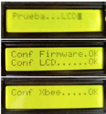
Figura 8. Ejemplos de mensajes de validación de pruebas en el SEI para un cliente dado.
