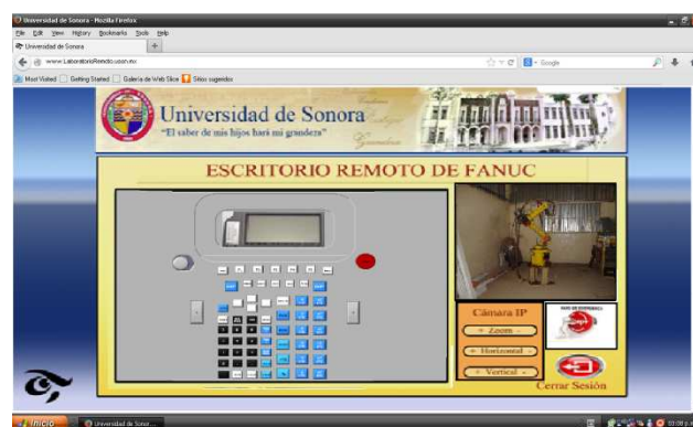
Fig. 4 Página para control remoto Robot FANUC.
