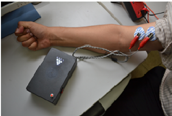
Fig. 7 Muestra la colocación de los electrodos y la barra de LED's donde se da una indicación del esfuerzo realizado.
