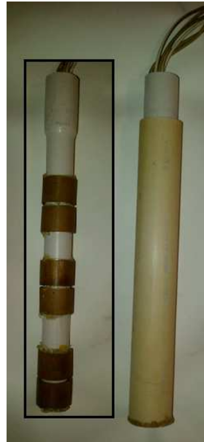
Fig. 1 Fotografía del sensor y tubo para campo agrícola.
