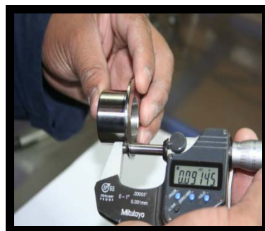
Figura 4. Forma de medir el grosor de la pestaña
