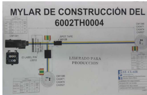
Figura 10. MYLAR de construcción.
