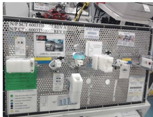
Figura 15. Tablero De Prueba Eléctrica.
