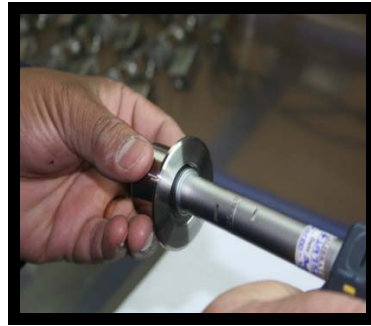
Figura 6. Forma de medir el diámetro interior de la pieza
