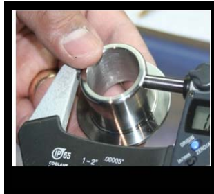
Figura 2. Como se debe medir el diámetro exterior.
