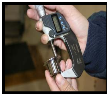
Figura 3. Como se debe medir el largo de la pieza.
