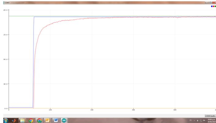
Nota: color azul: valor deseado; rojo: respuesta de velocidad del motor; verde: límite de velocidad de diseño.
