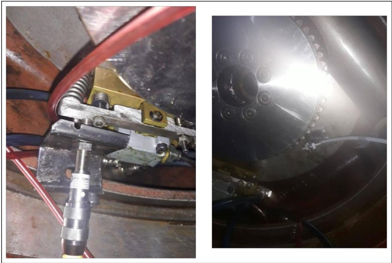
Figura 4. Sensores inductivos adecuados correctamente a la mesa indexadora
