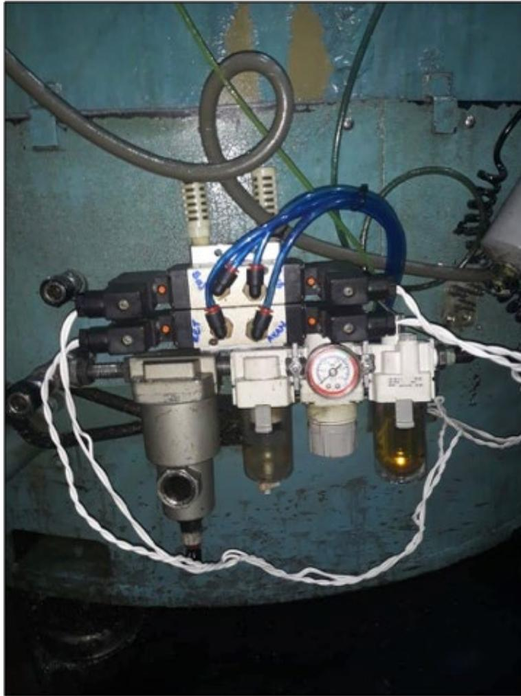
Figura 5. Electroválvulas de doble salida
