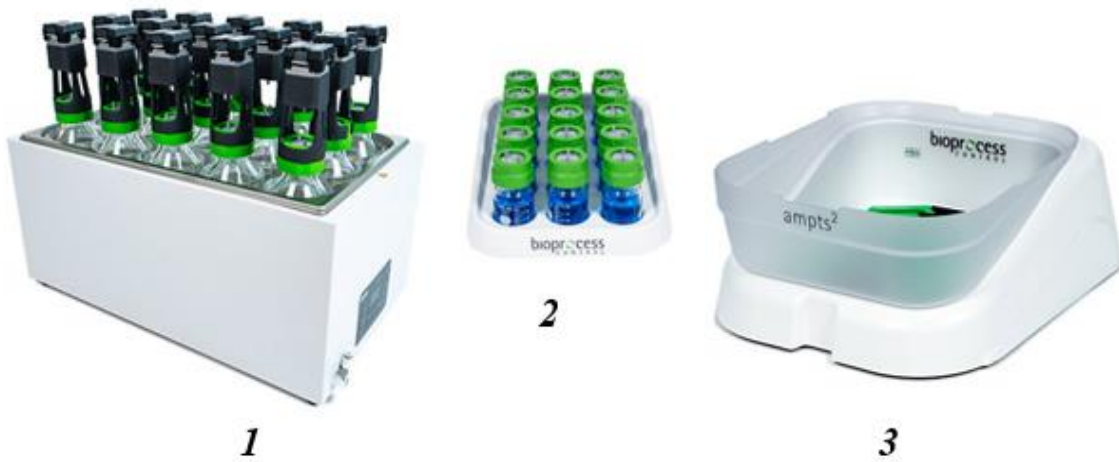
Figura 1. Sistema “Automatic Methane Potential Test System” (AMPTS®) II: 1) Incubadora con 15 reactores (500mL) en batch; 2) Unidad de absorción de CO 2 ; 3) Equipo de medición de flujo y volumen de gas producido
