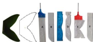
Figura 1. Perfiles de álabes oscilantes bioinspirados en la cola del bocachico.
