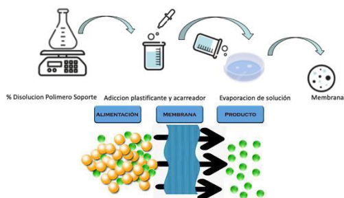
Figura 1. Preparación PIM y celda de transporte
