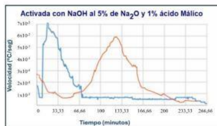
Figura 1. Calorimetría en Muestra de Escoria Siderúrgica Activada Alcalinamente con NaOH al 5% \text{Na}_2\text{O} , con y sin adición de Ácido Málico.
