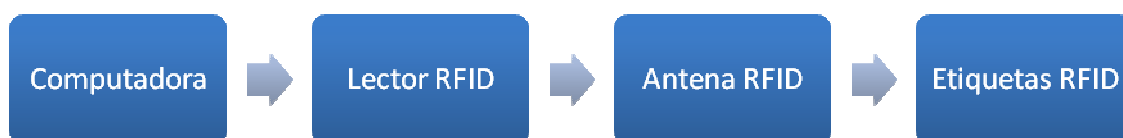
Figura 2. Sistema de RFID para control de inventarios diseñado y construido.
