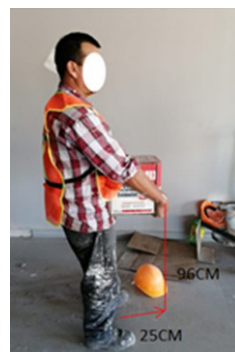
Figura 2. Evaluación de levantamiento del material 1 (NIOSH)
