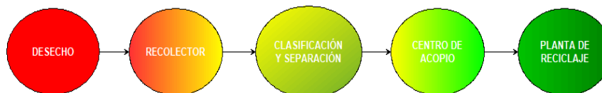
Figura 2. Sistema de abastecimiento de materiales recuperados
