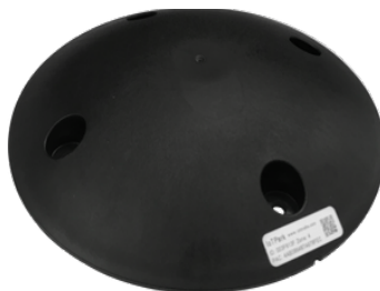
Figura 5. Dispositivo IoT Pak con sensor ferromagnético y acelerómetro Fuente: Fotografía propia, basada en la tecnología de IoT Solutions 2021.
