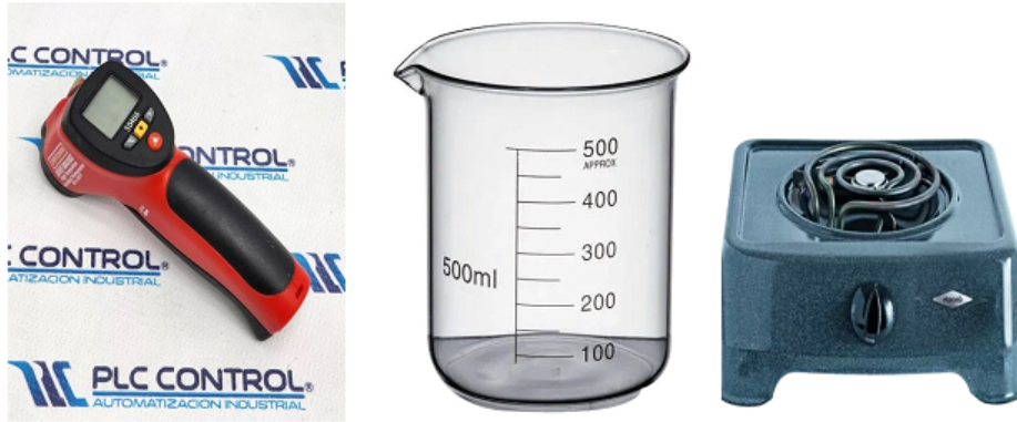
Figura 3. Elementos necesarios para la práctica La Ley de Enfriamiento de Newton .
