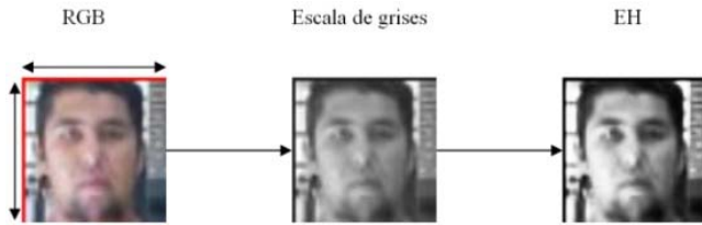
Fig. 4 Filtros aplicados a la región de interés.
