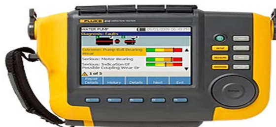
Figura 3.- Analizador de vibraciones Fluke 810.
